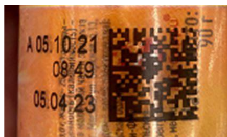
Печать кода маркировки на бликующей/светоотражающей поверхности
