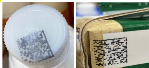
Смещение кода маркировки при печати
