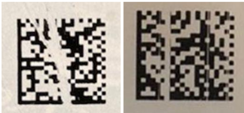
Нарушение целостности КМ*
