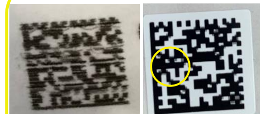
Смазывание кода маркировки или его отдельных элементов
